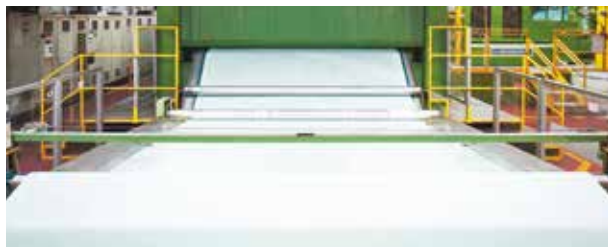
Aus wiedergewonnenem Polyester entstehen Vliesstoffe für Dachabdichtungen sowie Schall- und Wärmedämmung.
