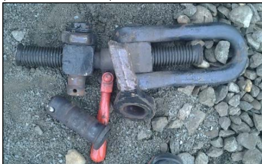
Afbeelding 12: foto van gebroken trekwerk (schroefkoppeling, 4 december 2014, Rotterdam) (foto's: Locon Benelux)
