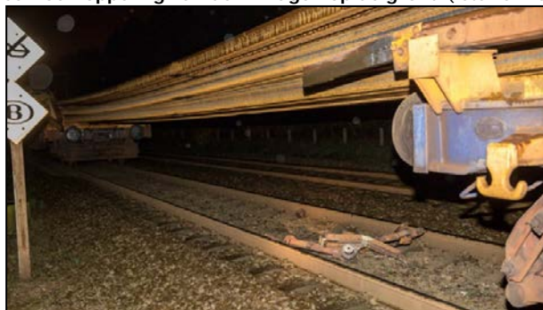
Afbeelding 9: foto van gebroken trein bij Nispen, op de voorgrond ligt het van trekwerk de schroefkoppeling van de 2 e wagen op de grond (foto: Omroep Brabant)
