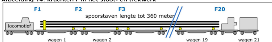
Afbeelding 15: krachten F in het stoot- en trekwerk – referentie
