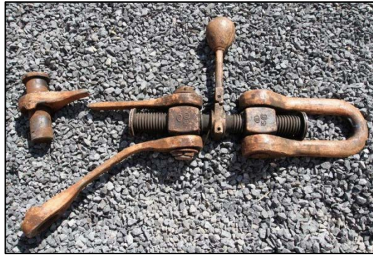
Afbeelding 13: foto van gebroken trekwerk (schroefkoppeling, 13 april 2015, Antwerpen) (foto's: Infrabel)
