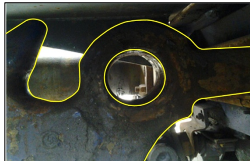
Afbeelding 12: foto van gebroken trekwerk (schroefkoppeling, 4 december 2014, Rotterdam) (foto's: Locon Benelux)
