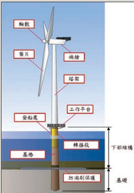
圖3 離岸風機及其單樁支撐結構示意圖
