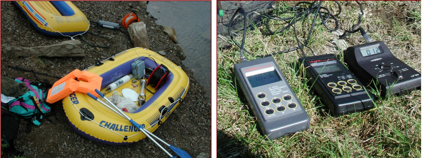
Polisonda multiparametrica e bottiglia di profondità per i prelievi a centro lago (a sinistra) e sonde per i rilievi da riva (a destra)
