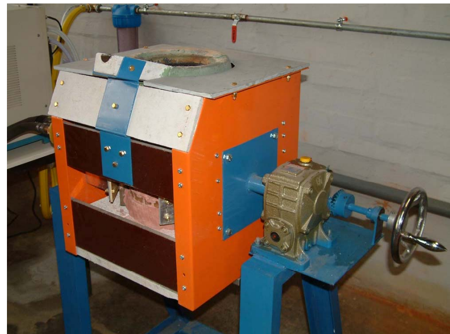
INDUKCIJSKA PEĆ KAPACITETA 30 kg ČELIKA
