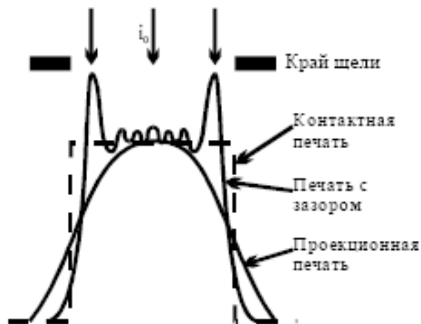
Рис. 2.2. Профили распределения интенсивности в изображении для случаев контактной печати, печати с зазором и проекционной литографии.
