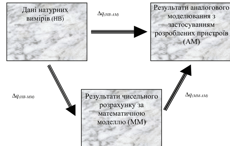
Рис. 5.1. Зіставлення погрішностей натурних вимірів, математичної, і аналогової (квазіаналогової) моделей процесів поширення звуку, призначених для визначення ефективності шумозахисних пристроїв:
