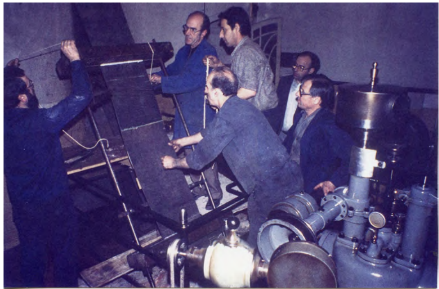
Mecànics de Gallifa arreglant la corretja de la turbina (dècada de 1970). Josep Maria Musach.
