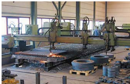
Bild 5-27: Brennschneidarbeiten an unbeschichteten Blechen
