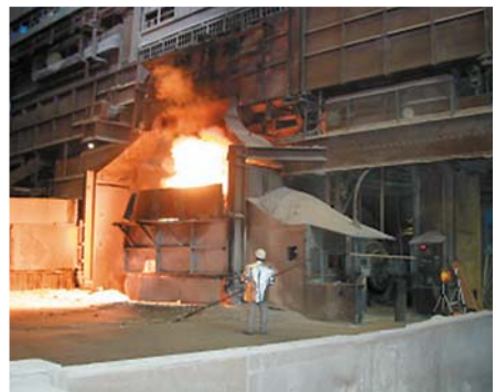
Bild 5-6: LD-Konverter während des Frischprozesses
