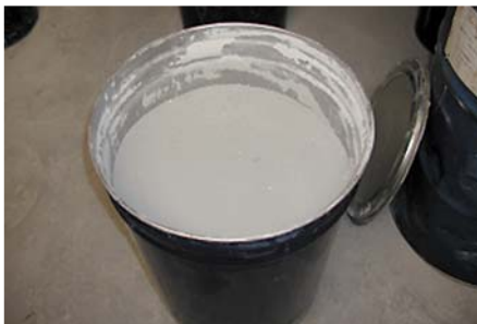
Bild 5-22: Filterstaub einer Buntmetallgießerei
