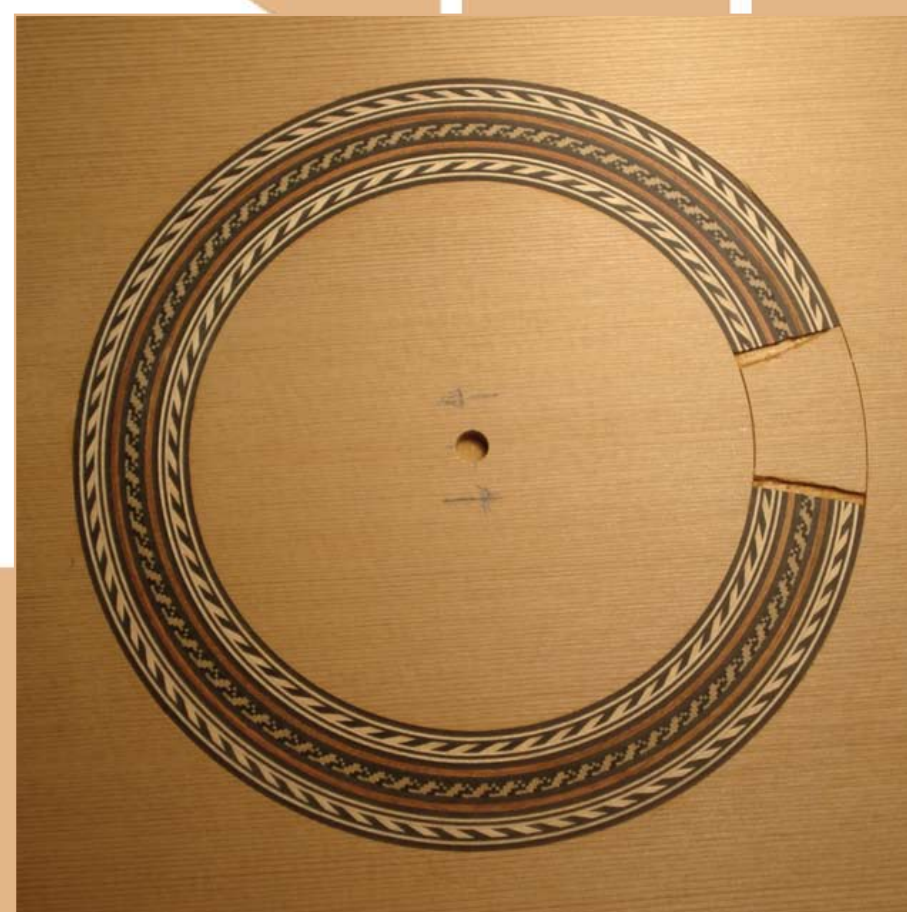
inleggen van de rozet
