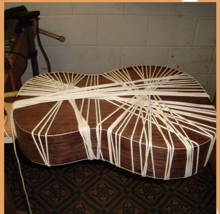
de gitaar is dicht, het touw zorgt voor een gelijkmatige druk op de lijmoppervlakken
