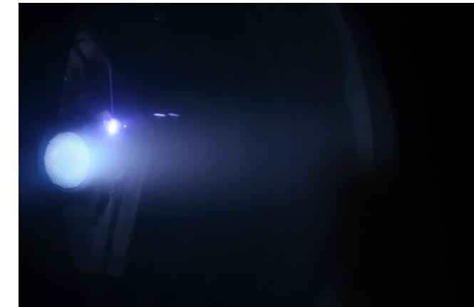
フライトモデルの真空チャンバ内での噴射試験の様子
