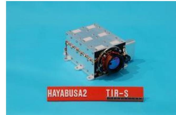
8~12μmでの撮像:小惑星表面温度を調べる
