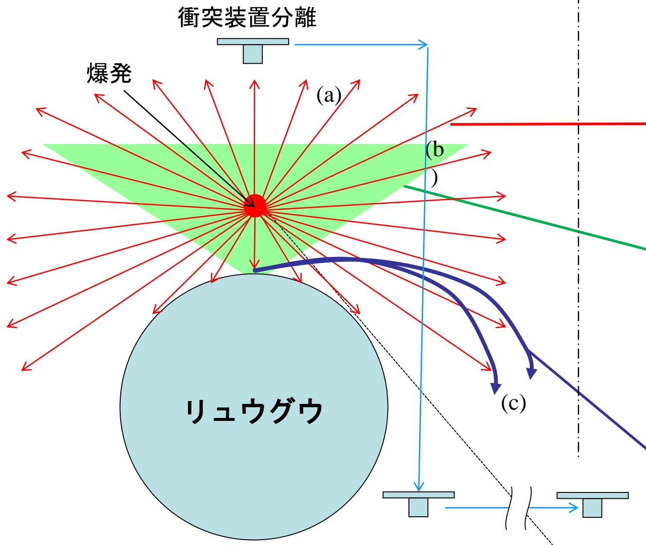
搭載型衝突機は小惑星上空で作動 (高度数100m)
