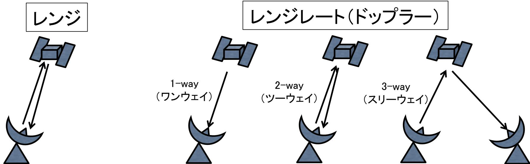
地上局から探査機に電波を送り、探査機から送り返されてくる電波の往復時間を測定すると、探査機までの距離が分かる。これを「レンジ」と呼ぶ。
