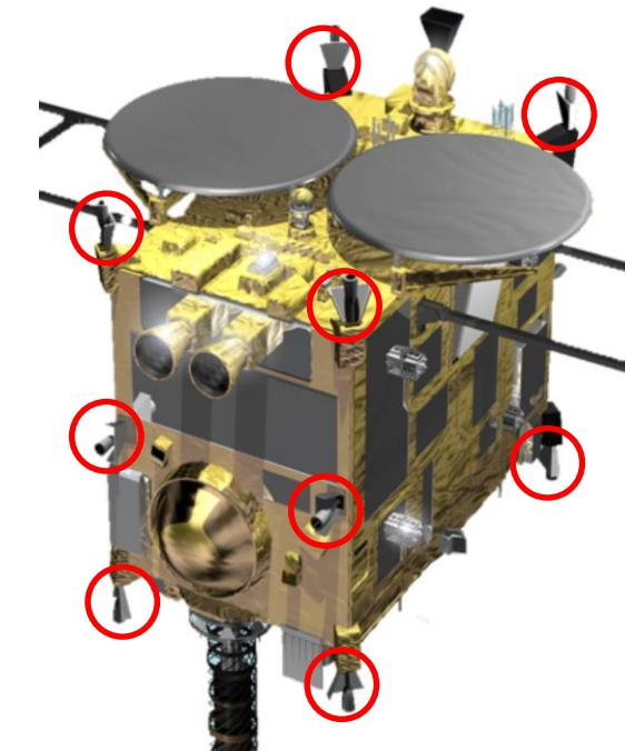
スラスターの位置を赤い丸で示した。見えてないものとして、下面奥に1つ、カプセルと反対の面(イオンエンジンの面)の上下の辺の中間に1つずつあるので、合計12個のスラスターがある。
