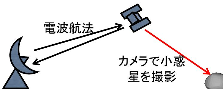
探査機に搭載しているカメラで小惑星を撮影すると、探査機から見た小惑星の方向が分かる。探査機の位置はDDORによりかなり正確に把握できるが、小惑星の位置には不確定性がある。探査機から小惑星の方向を確認しながら小惑星に正確に接近していく手法が光学航法である。
