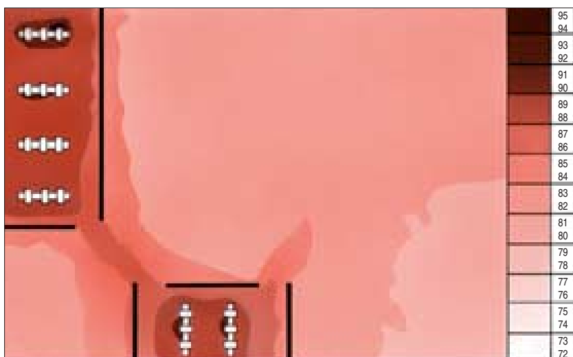
Figur 24. Beräknade ljudnivåer för produktionslokal (50 · 35 · 4 meter) med absorptionsfaktorn 0,2 hos tak och väggar samt skärmar runt de bullrande maskinerna
