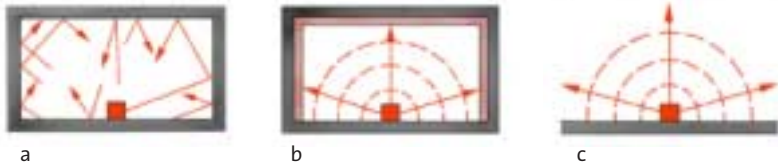
Figur 20. Rumsabsorptionens inverkan på ljudutbredningen inomhus. a=reflekterande väggar, b=absorberande väggar, c=fritt fält, ■ = Bullerkälla
