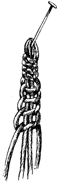
FIG. 58. — Détail du nœud simple ou nœud tournant.
