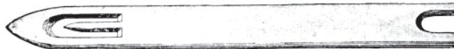
4. Filetnadel, Netzadel oder Schütze aus Holz zur Herstellung von Fischnetzen, Hängematten u. dergl.
