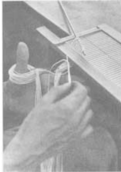
Abb. 44. Einzug der Kette in den Kamm
