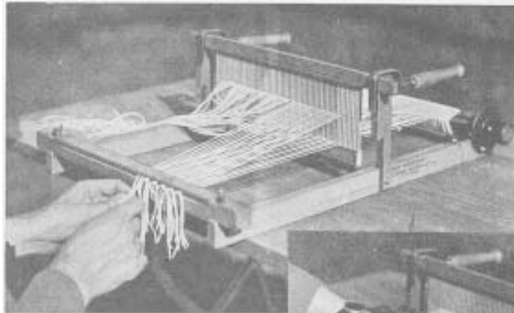
Abb. 47 a. Befestigen der Kette am Warenbaum
