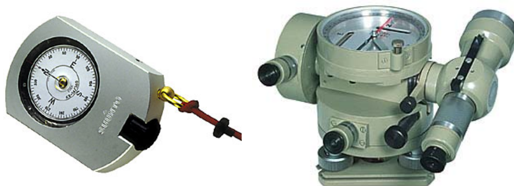
Abbildung 6.7: Suunto Taschenbussole und BREITHAUPT Tachymeterbussole (Abb. Aus dem Katalog der Fa. Grube).
