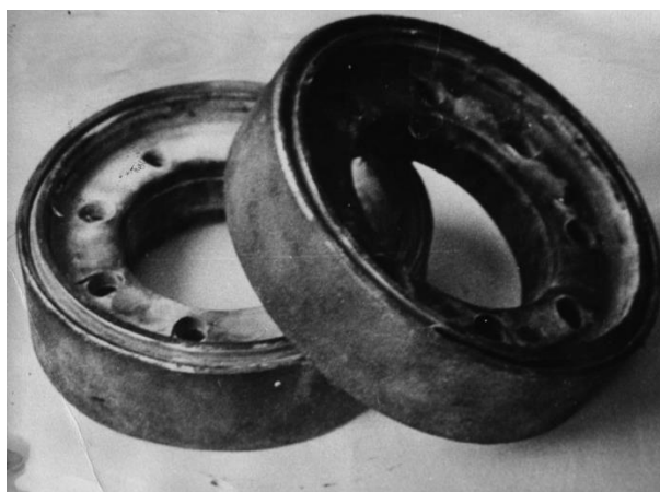
Рисунок 2 – Обод ведущего катка с амортизатором после восстановления
