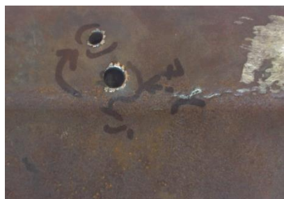
Рисунок 3 – Композиция, полученная сваркой взрывом, после прострела пластины пулями калибра 7.62 и 5.45:
