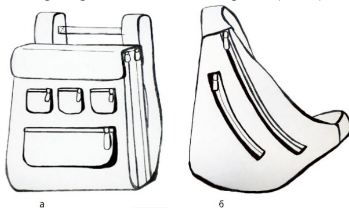
Ил. 1. Примеры «передних» рюкзаков для слабовидящих людей: а – рюкзак на двух плечевых ремнях; б – рюкзак на одном плечевом ремне
