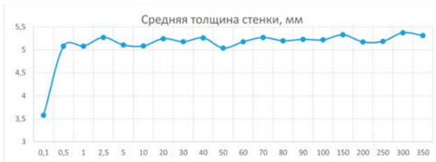
Рисунок 5 – Зависимость средней толщины стенки от скорости движения пуансона
