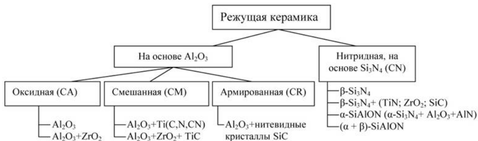
Рисунок 1 – Классификация режущей керамики по стандарту DIN ISO 513
