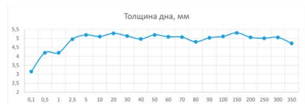
Рисунок 8 – Средняя толщина дна заготовки после операции свертки
