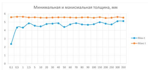
Рисунок 7 – Изменение максимальной и минимальной толщины стенки
