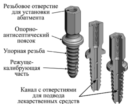
Рисунок 1 – Имплантат с центральным отверстием для ввода лекарственных препаратов (патент РФ №152558)
