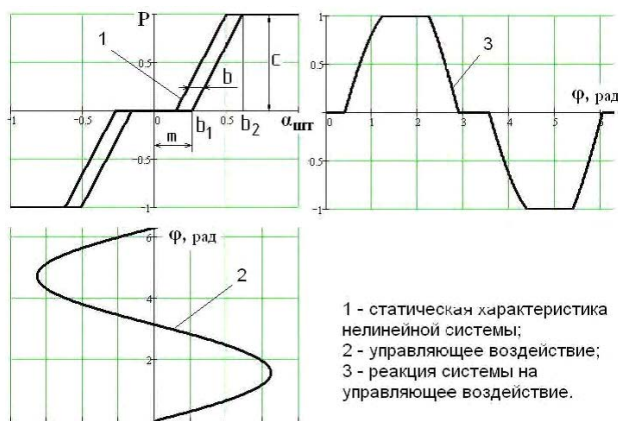
Рисунок 8 – Параметры характеристики системы управления поворотом с ГОП
