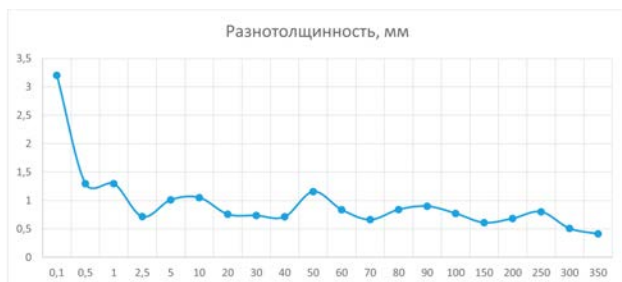
Рисунок 6 – Зависимость разнотолщинности от скорости движения пуансона
