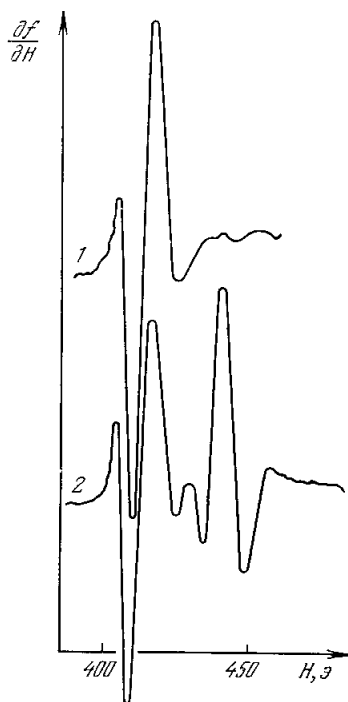
Рис. 24. Расщепление линий РЭ на клиновидном образце индия.
