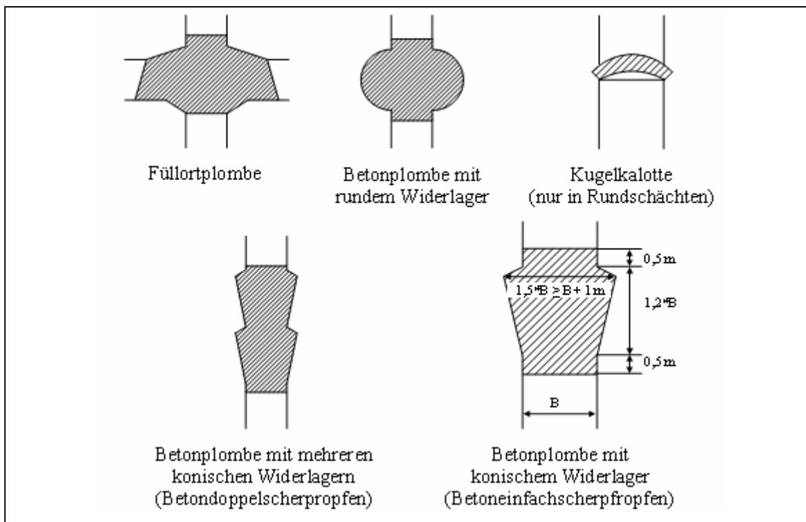
Bild 1: Schematische Darstellung von verschiedenen Formen massiver Betonplomben
