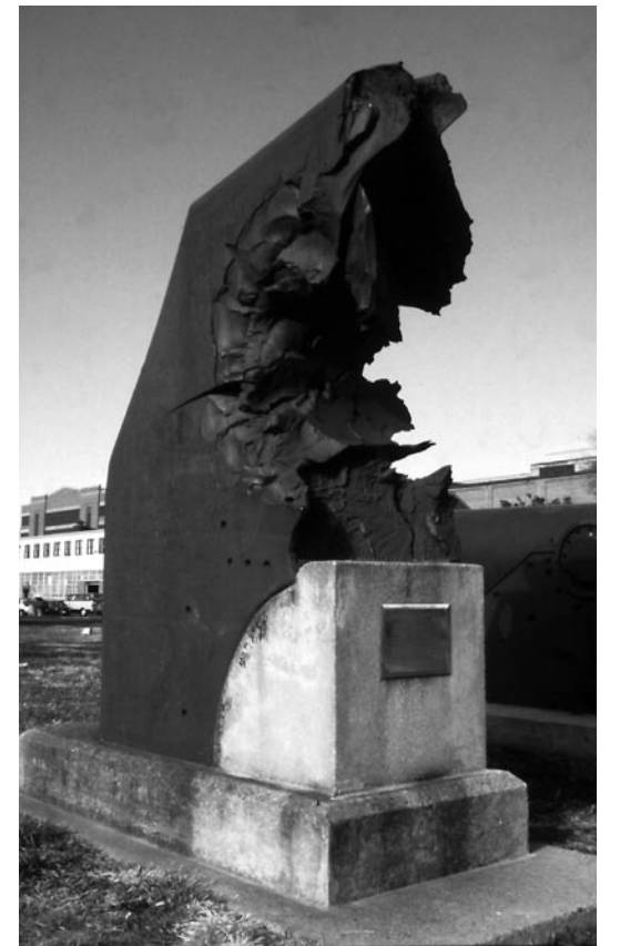
ワシントン海軍工廠に展示されている主砲塔用の装甲板。
