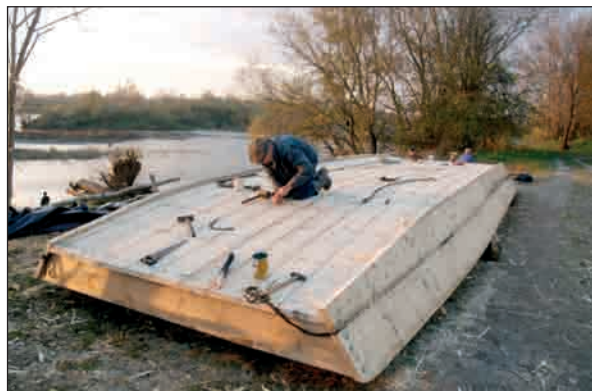
Il. 24. Etapy sporządzania jednostki metodą płaskiego dna na przykładzie budowy współczesnego promu w Basonii w 2008 roku (fot. R. Łapiński)
