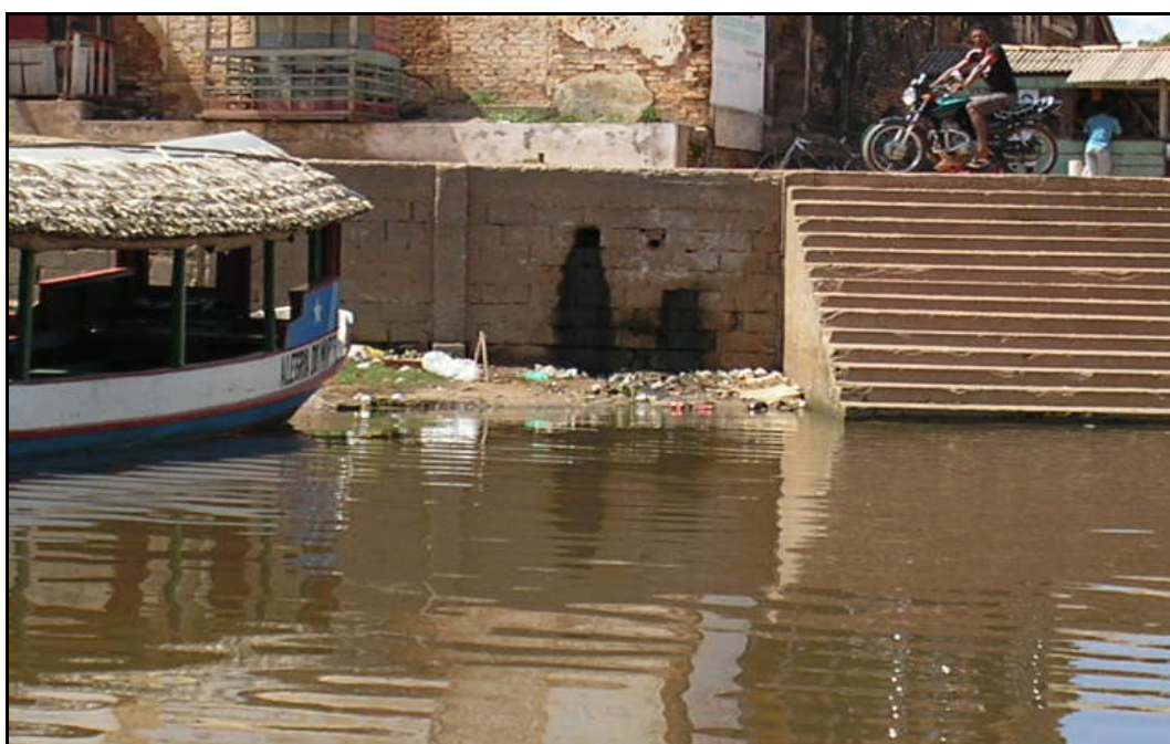
Figura 14 – Porto de Penalva evidenciando esgoto lançado in natura e lixo acumulado nas margens do lago Cajari.
