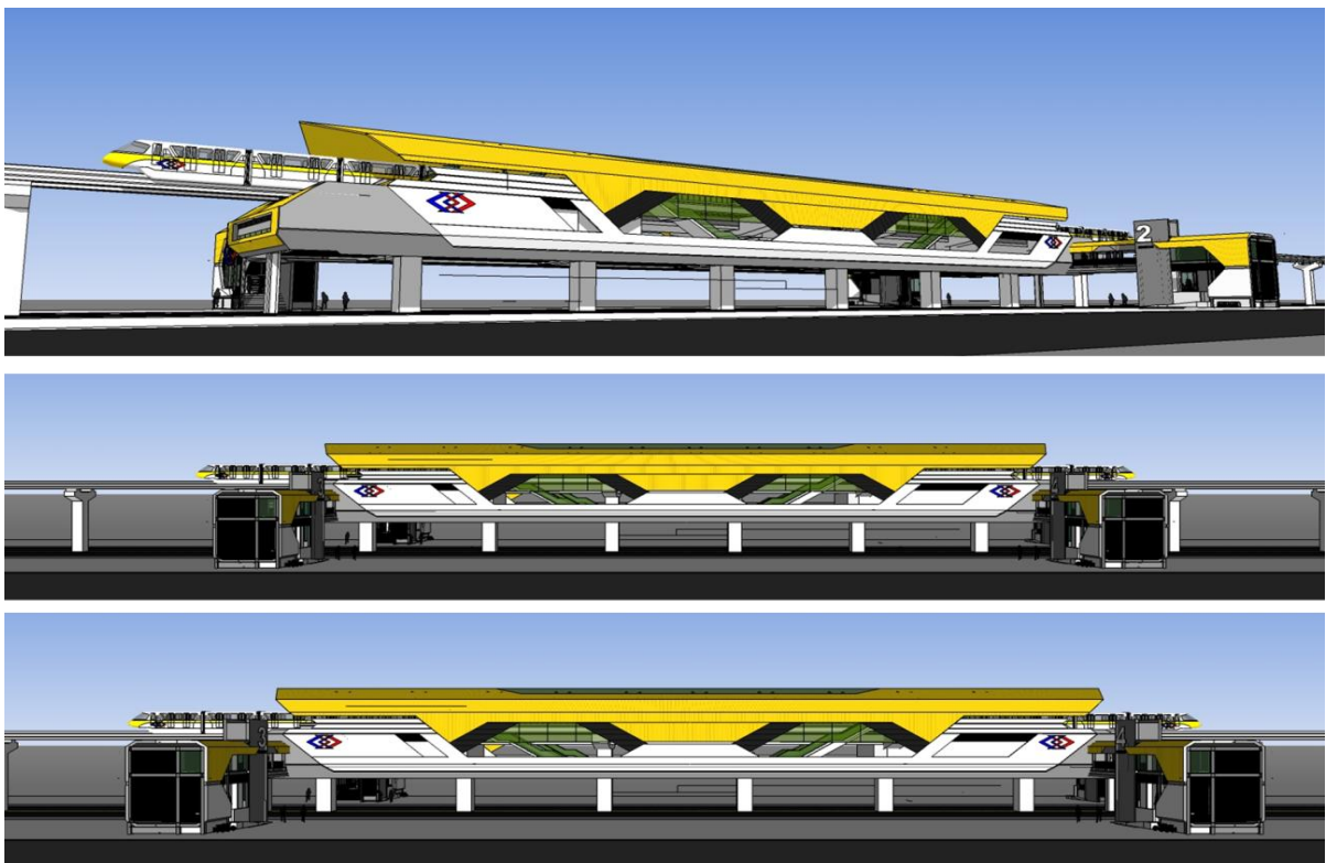
รูปที่ 3.5.2 - 1 รูปแบบสถานีรถไฟฟ้าแบบชานชาลาด้านข้างแบบ 2 ชั้น (Side Platform 2 Stories)
