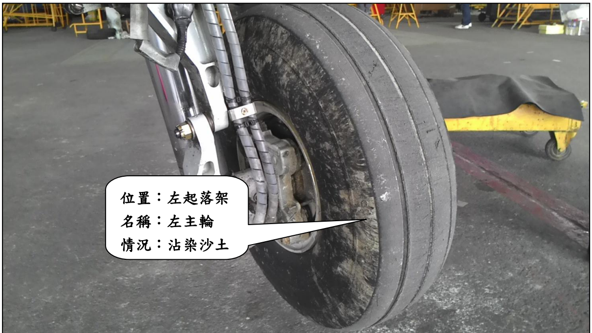
圖 1.6-4 左主輪沾染沙土
