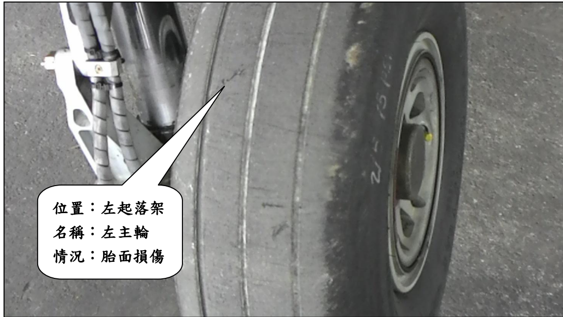
圖 1.6-1 左主輪胎面損傷
