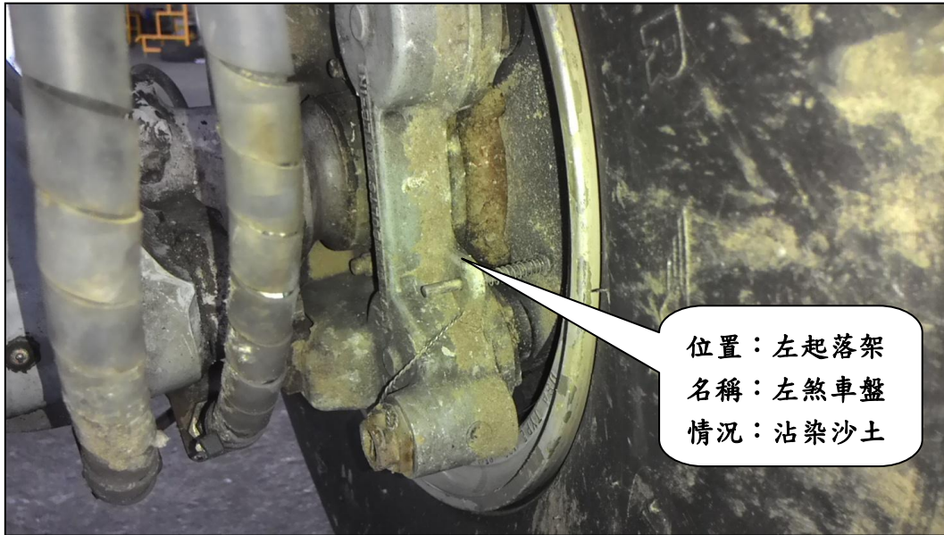
圖 1.6-5 左煞車盤沾染沙土
