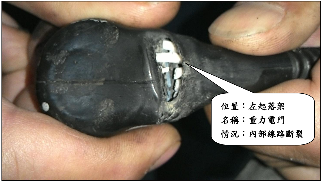
圖 1.6-3 左起落架重力電門內部線路斷裂
