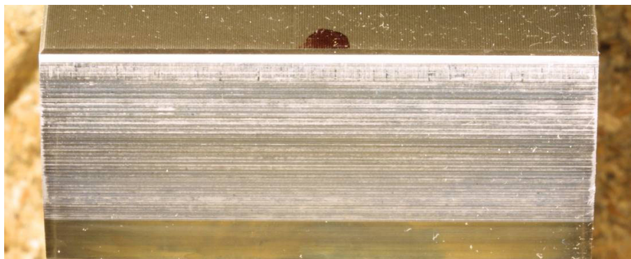
Bild 4.29: Zahnflanke des Rades der Verzahnung GG3 1212 mit einer arithmetischen Mittenrauheit von R_a = 0,48 \mu\text{m} , Seite 2, m_n = 22 \text{ mm}
