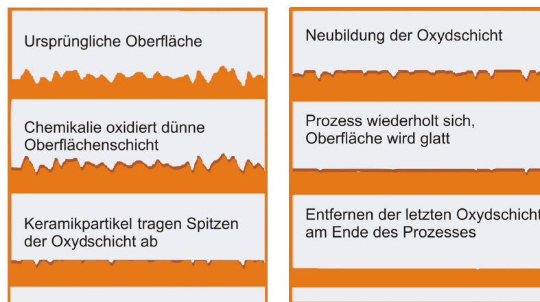
Bild 3.1: Verfahrensprinzip des chemisch-mechanischen Gleitschleifens
