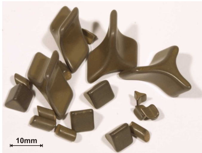
Bild 3.2: Keramikpartikel mit einer Härte nach Mohs von neun
