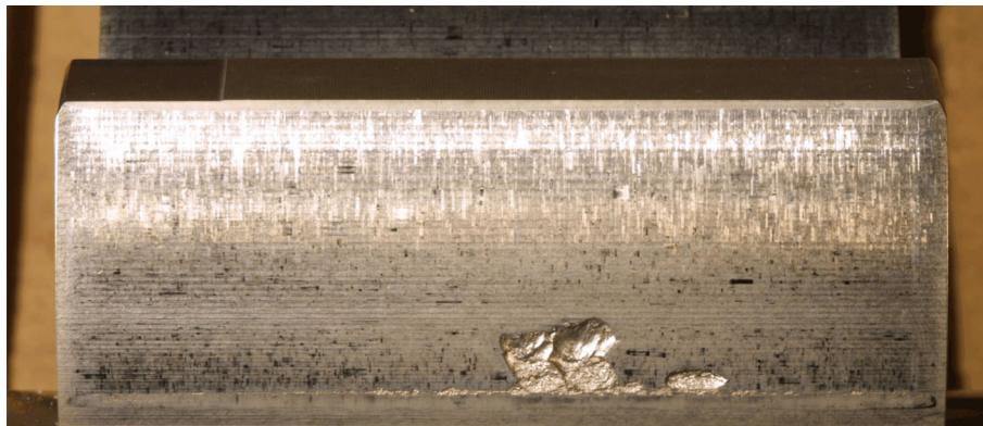
Bild 4.4: Zahnrad GG3 1211-1: Grübchenschaden nach Laststufe 10, Seite 2, m_n = 22 \text{ mm}
