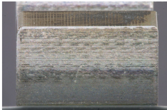
Bild 4.2: Radflanke der Verzahnung GG3 2211, Seite 1 mit Ca = 0 \mu\text{m} , m_n = 4,5 \text{ mm}
