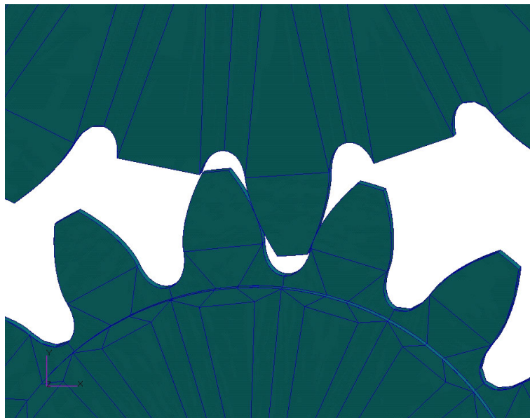
Bild 5.18: Modell mit gelöschten Nachbarzähnen zur Bestimmung der Zahnpaarsteifigkeit
