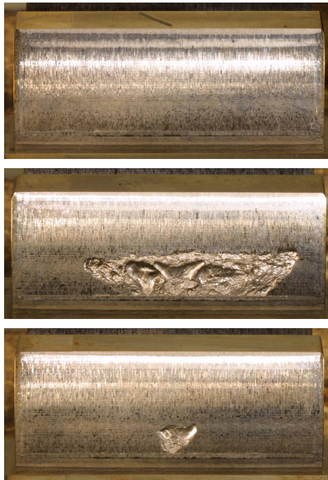
Bild 4.21: Grübchenschäden der Verzahnung GG3 1211-2 Seite 1 im ersten Lauf des Dauertests nach 15,8 Mio. Lastwechsel am Ritzel, m_n = 22 mm
