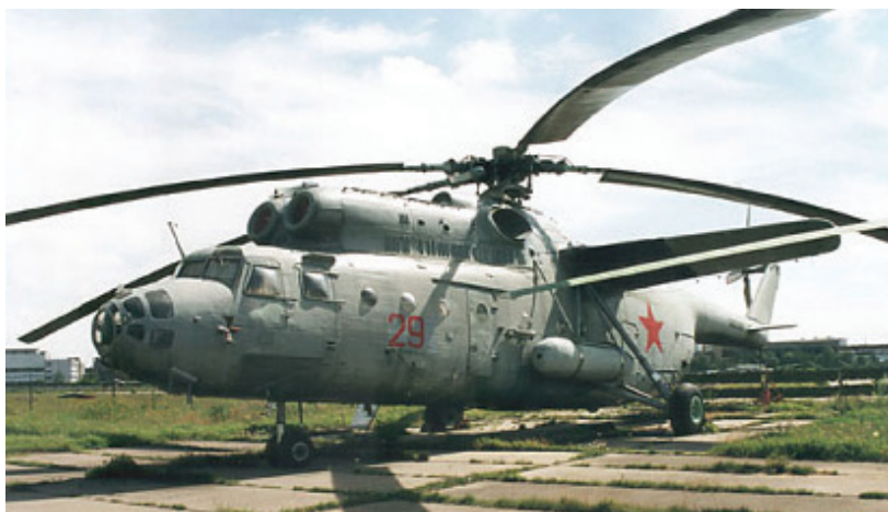
На вертолете МИ-6 находилась летающая лаборатория для проведения летно-конструкторских испытаний аппаратуры РТЗ.
