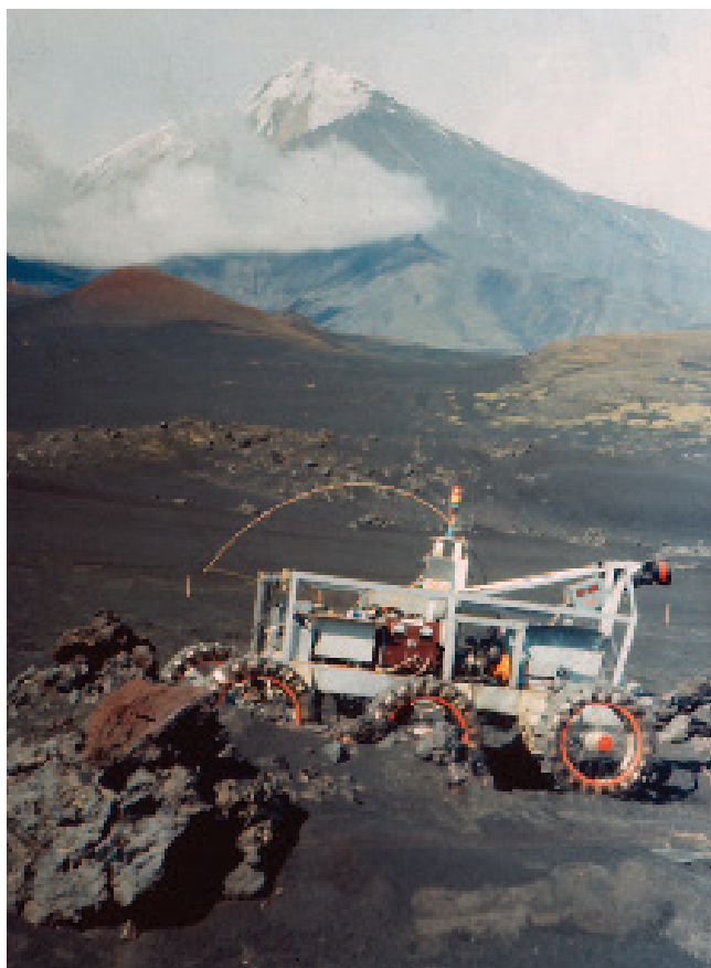
Фрагмент испытаний движения робота-марсохода в автономном режиме на Камчатке в 1985 г.
