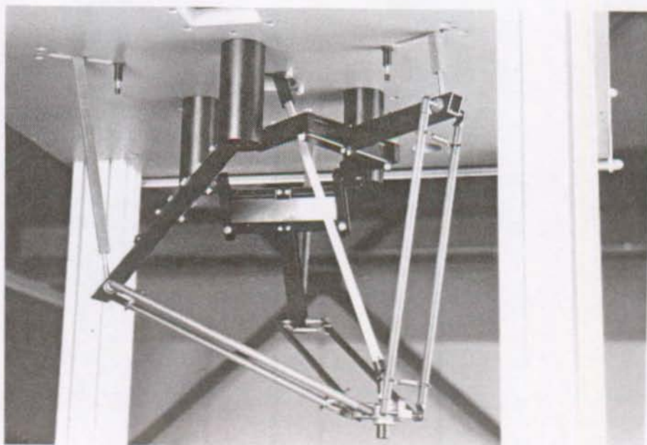
Fig.7.6 Vue de la cinématique du modèle industriel DELTA 700.
