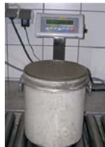
Le poids du béton rempli dans un récipient est divisé par le volume du récipient.
