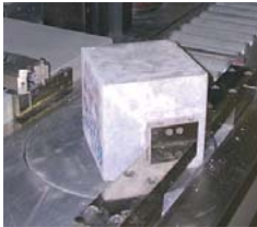
Masse volumique du béton durci (EN 12390-7)
