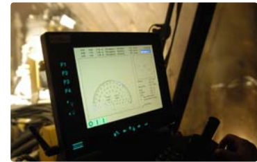
Hydraulische Steuerung des Bohrhülbo
