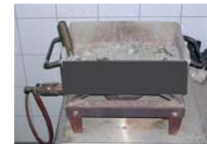
Séchage d'un échantillon de béton frais sur un réchaud. La différence de poids (poids humide - poids sec) indique la teneur en eau.
