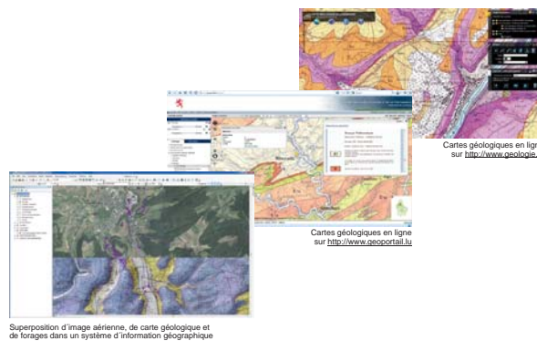
Superposition d'image aérienne, de carte géologique et de forages dans un système d'information géographique
