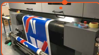
impression du fichier sur une imprimante avec la technologie de séchage LED UV (séchage très rapide)
