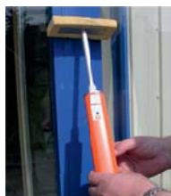
Détecteur de porosité avec éponge plate
