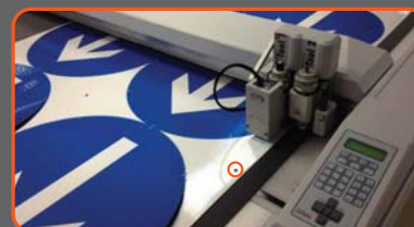
découpe du vinyle imprimé et laminé à l'aide d'une caméra détectant les points noirs appelés "Videomärke"
