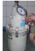
Cette méthode consiste à égaliser un volume d'air connu, à une pression connue dans une enceinte hermétique, avec le volume d'air inconnu de l'échantillon de béton.
