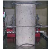
Module d'élasticité (DIN 1048 Teil 5)
