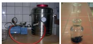
Masse volumique réelle (EN 12967-5)
