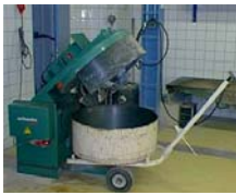
Confection d'un mélange de béton au labo ou essai sur un mélange provenant d'un chantier
