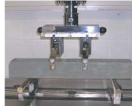
Résistance à la flexion sur poutres (EN 12390-5)
