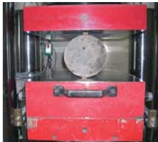
Résistance en traction par fendage d'éprouvettes (EN 12390-6)
