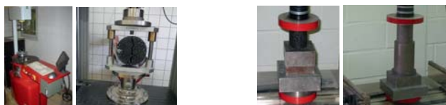
Sensibilité à l'eau: méthode A ITSR ou B Duriez (EN 12967-12)
