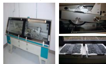
Essai d'ornièrage (EN 12967-22)
