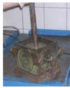
Remplissage des moules en 2 couches, vibration de chaque couche à refus, conservation en chambre humide
