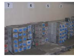
Stockage dans la chambre humide à 20^{\circ}\text{C} \pm 2^{\circ}\text{C} et humidité relative > 95\%
