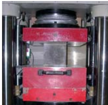
Résistance à la compression des éprouvettes (EN 12390-3)
