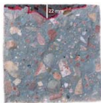
Profondeur de pénétration d'eau sous pression (EN 12390-8)
