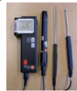
Indicateur + sondes d'humidité / d'immersion / de contact
