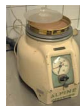
machine de tamisage dans un jet d'air
