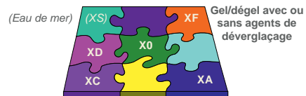
XC carbonatation corrosion des armatures
