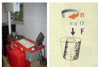
Presse à cisaillement giratoire (EN 12967-31)
