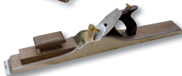
Raubank A1, 71,2 Zentimeter lang, 63,5 mm Eisenbreite, mit afrikanischem Rosenholz: 6,5 Kilogramm Schwungmasse!
