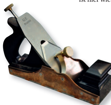
Der fertige (aber noch unpolierte) Putzhobel: 2,6 Kilogramm schwer, Gesamtlänge 255 Millimeter, Schneidenbreite 2 ¼ Zoll (57 Millimeter).
