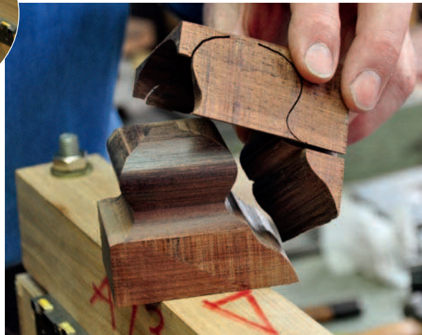
Die Holzteile schneidet Fritsche ebenfalls selbst: Mit einem ungeschränkten Metall-sägeblatt auf der Bandsäge.
