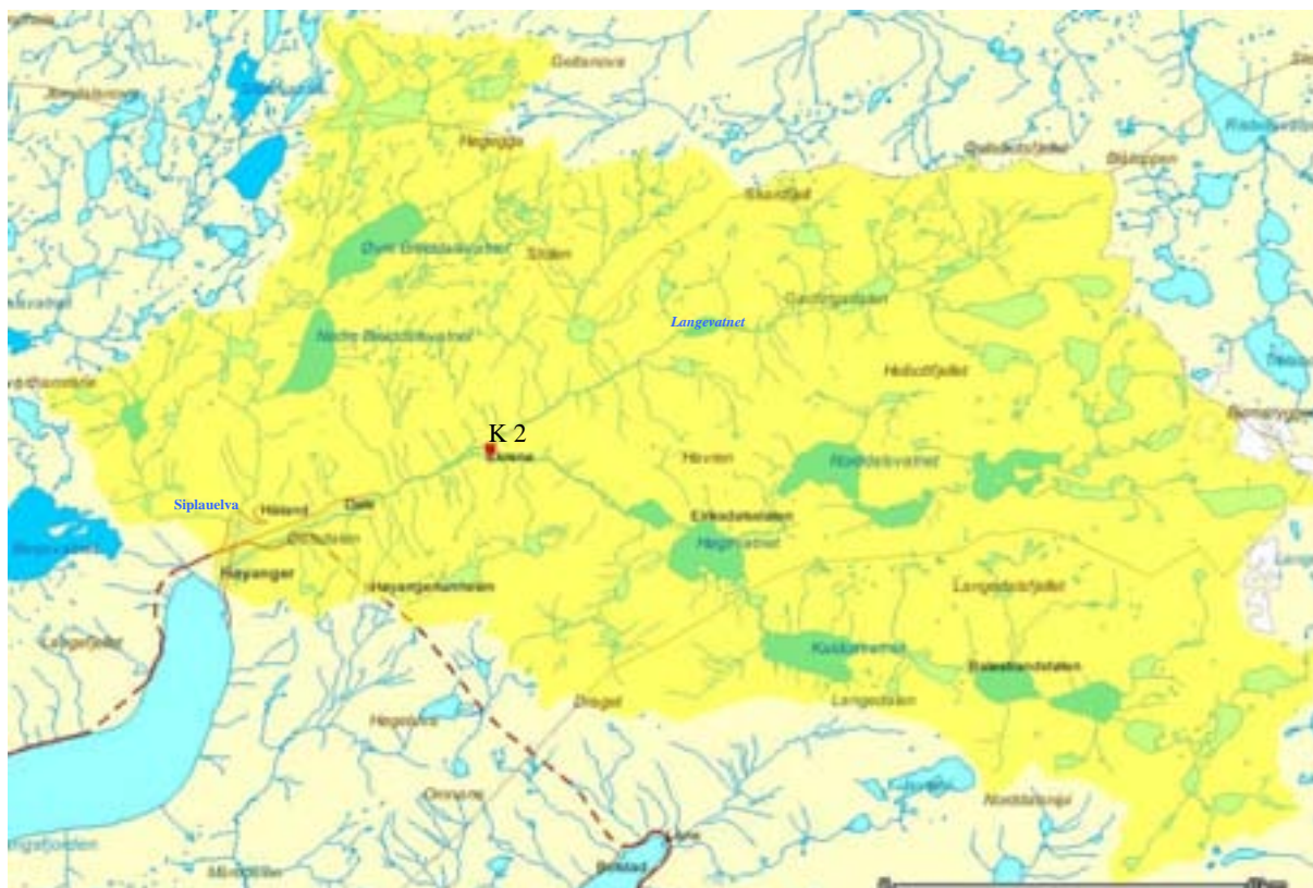
Figur 7: Høyangervassdraget med sitt naturlige nedbørfelt (kart fra NVE). Kraftstasjonen K2 er markert. Vandringshinderet for anadrom fisk er vanligvis utløpet av K 2. Vassdraget er sterkt regulert, se Figur 8.
