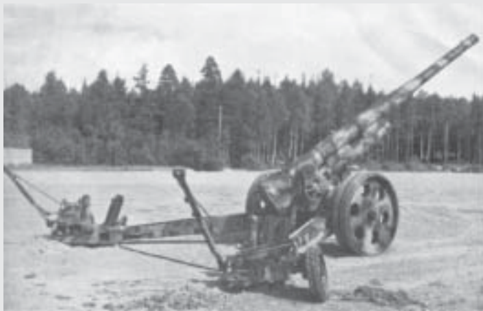
15,2 cm kustartilleripjäs m/37. Pjäsen kan sidriktas 60 grader inom lavetten. Då annan skjutriktning anges måste spadpålarna vid lavettbenens baksida tas upp och pjäsen svansas.
