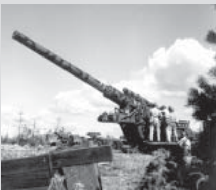
21 cm kanon m/42. Karakteristiskt för denna kanon var dess långa eldrör. Eldrörlängd mäts i kaliber, denna kanon hade kaliberlängd L/45 (15,2 cm m/37 hade L/43). Eldrörlängden anpassas för att ge maximal mynningsenergi i förhållande till kanonens vikt. Ett långt eldrör ger högre mynningshastighet.
