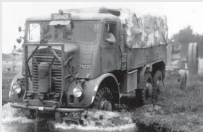
Dragterrängbil m/39 Skodatraktorn. Bilen var sexhjulsdreven, hade en 95 hk bensinmotor och var försedd med vinsch. Sammanlagt 211 stycken anskaffades. Den fanns även i en variant med dubbelhytt, som rymde halva pjäs-bemanningen
