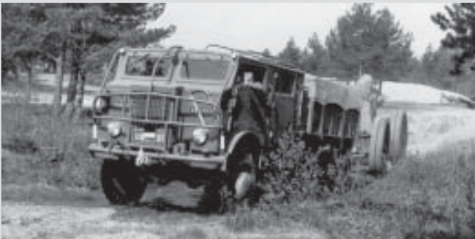
Volvo dragterrängbil m/42. Bilen var sexhjulsdreven, hade en bensinmotor på 108 hk och var försedd med vinschoch tryckluftsbromsar. Sammanlagt 57 stycken anskaffades
