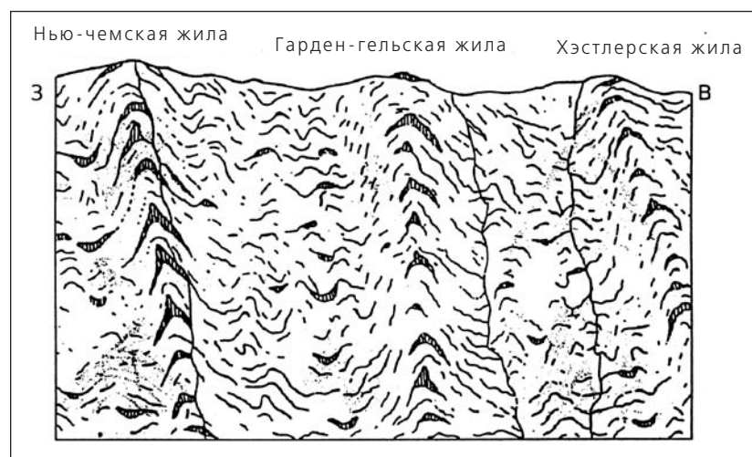
Идеальный разрез золотого месторождения Бендигго (Австралия) с седлообразными жилами (Г.Берг, 1933).
