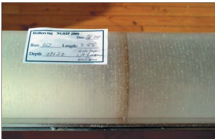
Керн, извлеченный из скважины NGRIP-2 с глубины 1886 м. Отчетливо виден прослой с частицами вулканического происхождения.
