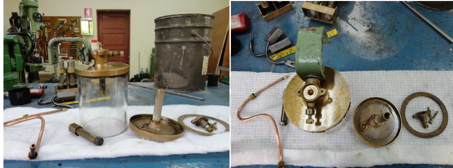
Fig.51 – Limpieza sistema de lubricación de motor
