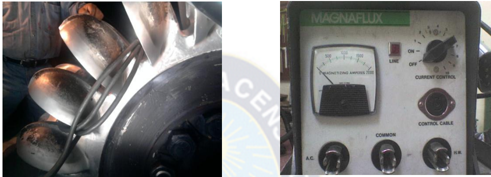
Fig. 24 – Inyección de Corriente Magnetizante a Bobina con Equipo Magna Flux.
