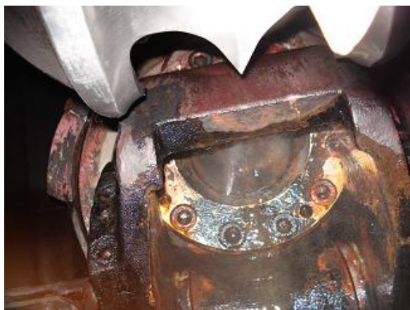
Fig.8 - Deflector en Posición Desvió de Chorro.
