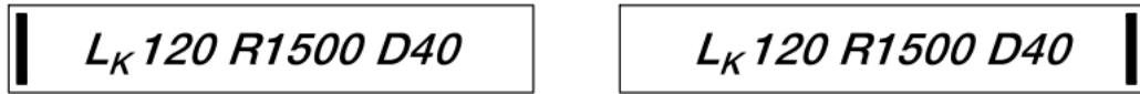
Kuva 17.8:26. Siirtymäkaaren alkukohta ja pituus sekä kaarresäde ja raiteen kallistus siirtymäkaaren toisessa alkukohdassa.
