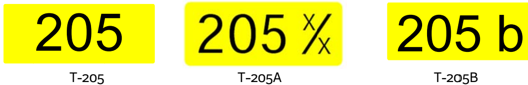
Kuva 17.8:20. Vaihteen erotusmuuntajakeskuksen tunnus.
