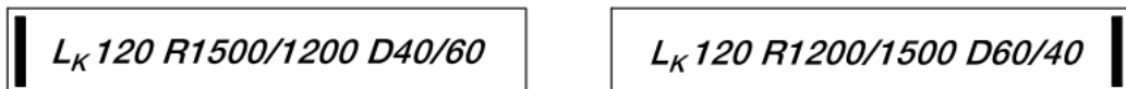
Kuva 17.8:30. Siirtymäkaaren alkukohta ja pituus sekä kaarresäde ja raiteen kallistus siirtymäkaaren alkukohdissa. Merkinnän ensimmäinen kaarresäde ja raiteen kallistus osoittavat kaarresädettä ja raiteen kallistusta merkinnän osoittamassa alkukohdassa.
