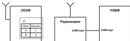
Рисунок 4.3 – Схема подключения счетчика CE208 к ПЭВМ через радиointерфейс
