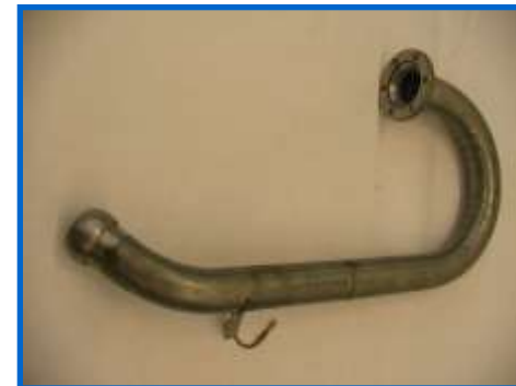
Трубопровод топливной системы двигателя НК-16-18СТ
