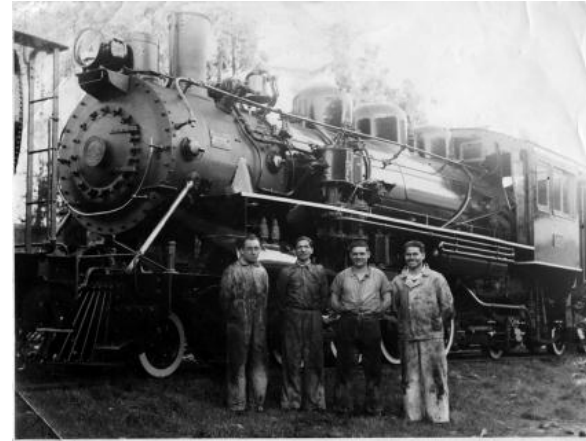
Fig. 23: Maestranzinos y 6° locomotora construida en la MCSB 3562 tipo W. Fuente: Gentileza de Dino Rojas.
