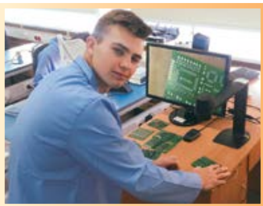
Sprawdzanie poprawności montażu elektronicznego pod mikroskopem
