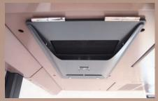
鉄道車両用プラズマクラスターイオン発生機を設置し 衛生的な車内環境をご提供します。
