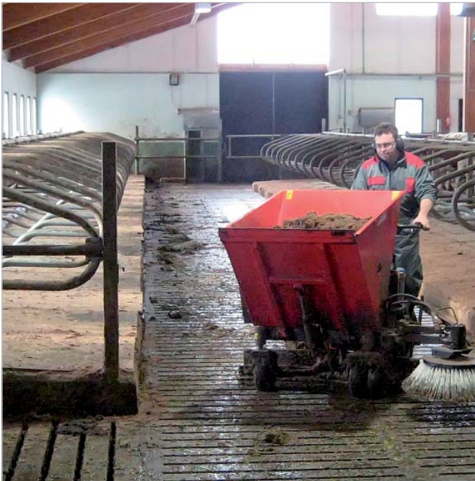
Käsin ohjattava kuivituskone harjaa ja kuivittaa parret, sekä kolaa lantakäytävää. Koneessa on vetävät pyörät.
