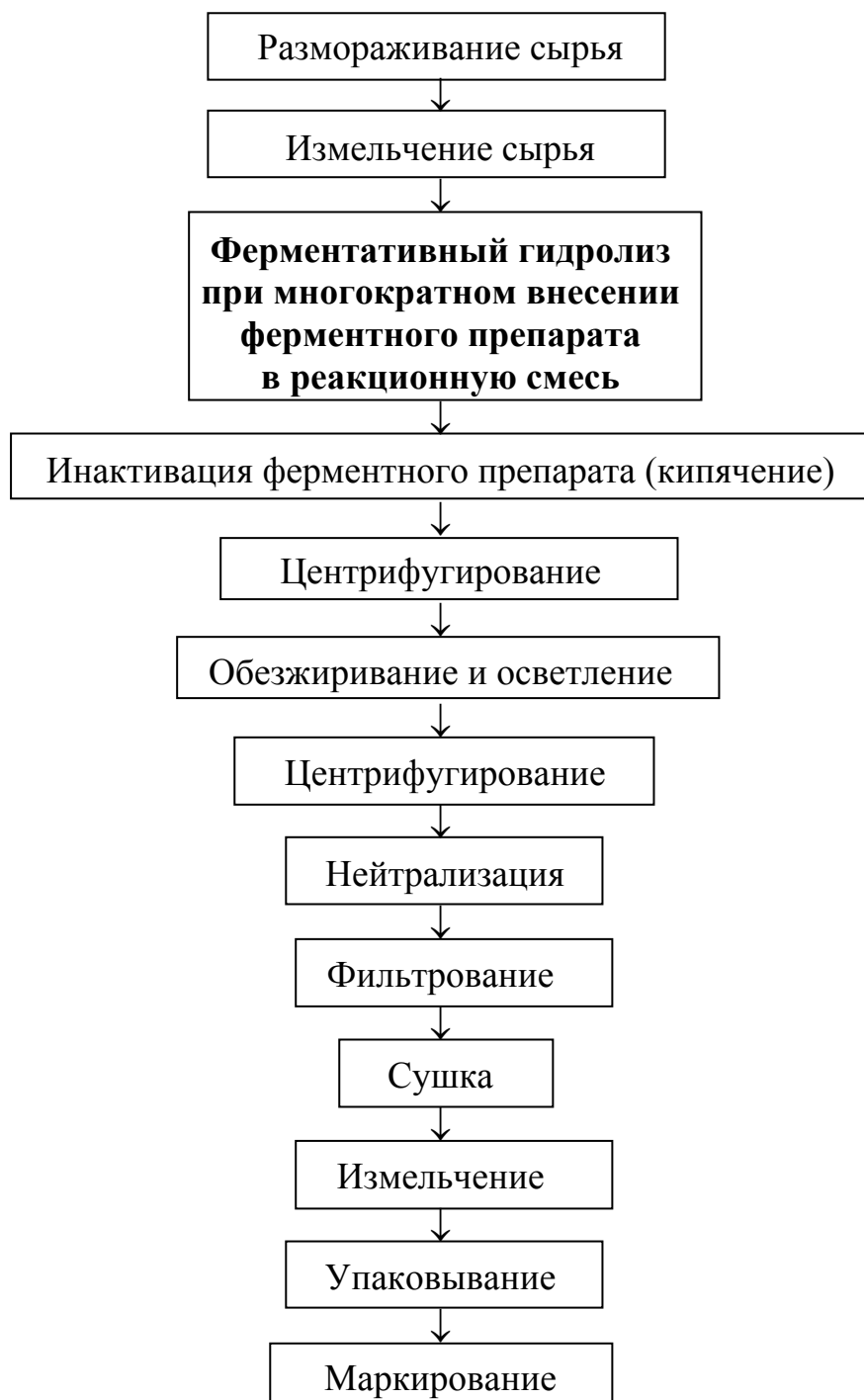
Рис. 4.35. Схема модифицированной технологии получения ферментативного белкового гидролизата
