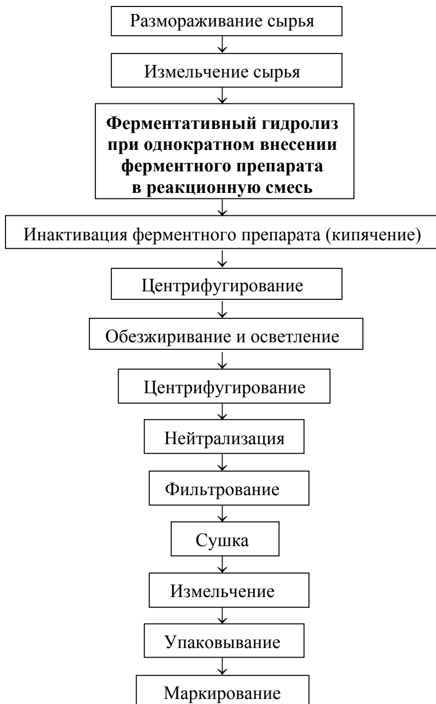
Рис. 2.1. Схема традиционного способа получения ферментативного белкового гидролизата
