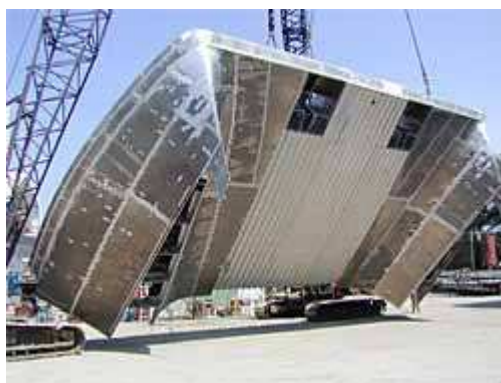
Рис. 10 Носовая часть военного судна “Sea Fighter” класса X-Craft производства Nichols Bros
