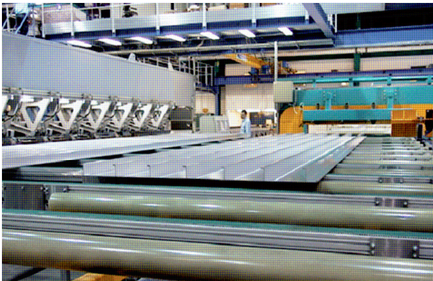
Рис. 7 Сварка палубных панелей длиной до 25 м и шириной до 3,5 м
