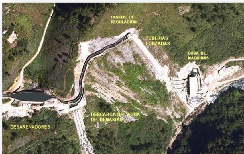
Fig. No 1.15. Vista global de los últimos componentes del Canal de Conducción.
