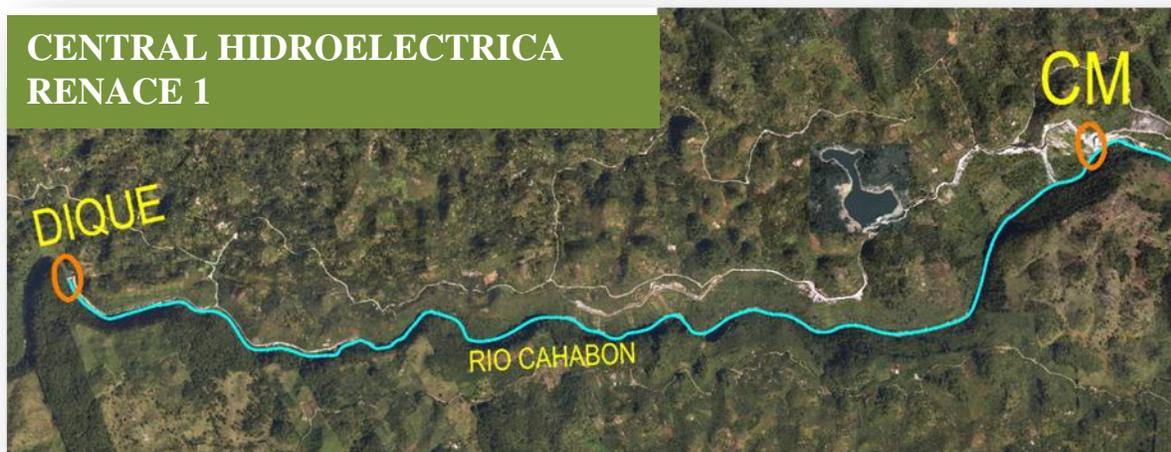
.No1.03 - FUENTE: IGN Entre Circulos el inicio y final del Sistema Hidroeléctrico Cahabón
