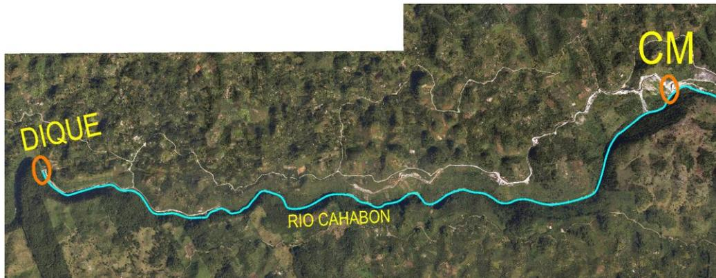
Fig. D.2 Mapa del cauce principal del río en la foto aérea del 2006. La franja del espejo de agua para la crecida milenaria tiene un ancho entre 30 y 80 m.
