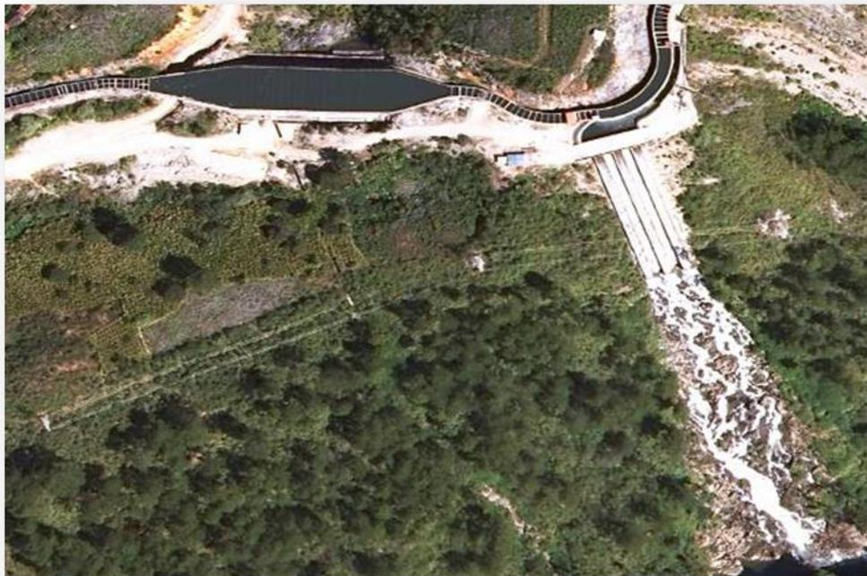
Fig. No 1.10. Note la sección del desarenador, como dos trapecios irregulares simétricos, luego sigue el rebosadero con sus tres vertientes paralelas, con perfil tipo Salto de Squi (ver esquina inferior derecha y Fig.No. 1.11), hacia el río Cahabón.
