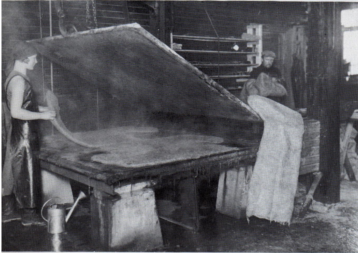
Vilttauskone (höyrypieno) Aino Akkanen ja Jaakko Puumala.
