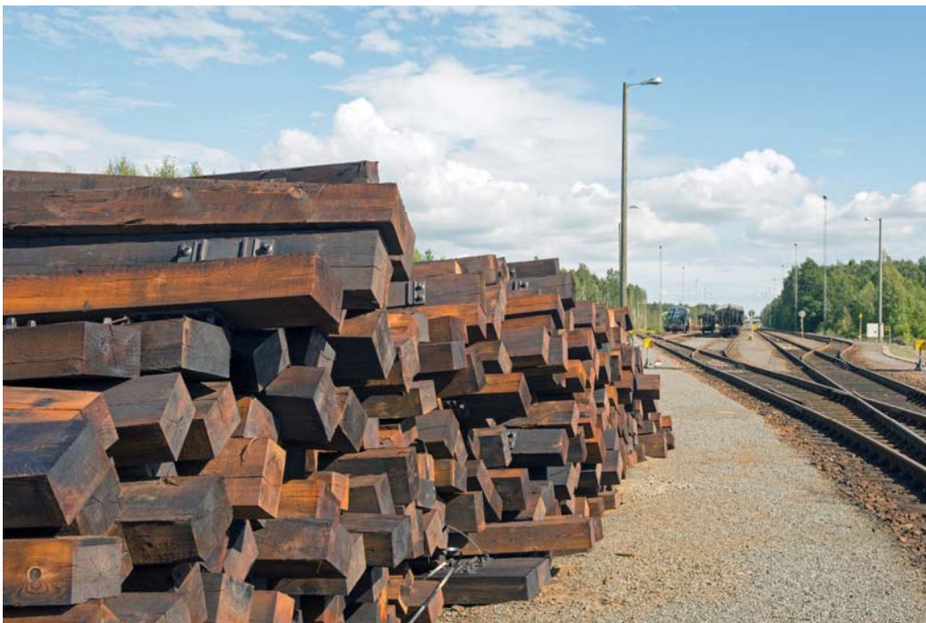
Kuva 2. Uusia kreosottipölkkyjä odottamassa asennusta rataan Mäntyluodossa 11.7.2016.
