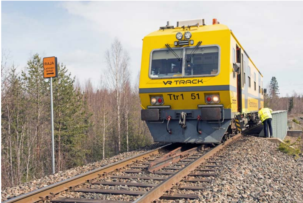
Kuva 88. EMMA-radantarkastusvaunu Lahnaslammella valtion rataverkon ja yksityisen rataverkon rajalla 7.5.2017.
