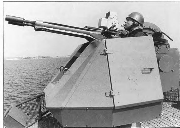
Alukset suojautuvat tykein ja ohjuksin ilmauhkaa vastaan. Kuvassa merivoimien modernisoima 23 mm:n ilmatorjuntatykki. Samaa tykkiä, joskin hieman eri näköisenä, käytetään myös maavoimissa. SA-kuva.
