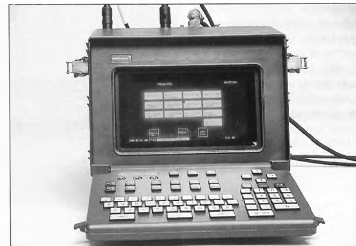
Järjestelmän ytimenä toimiva keskussanomalaite.
