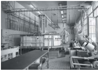
Annexe nord : atelier de nickelage, installation automatisée de traitement chimique des surfaces, 1958.
