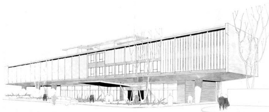
Avant-projet de Georges Addor, 1955 : une fine barre de 90 mètres sur 11, de deux étages sur pilotis (DAEL).
