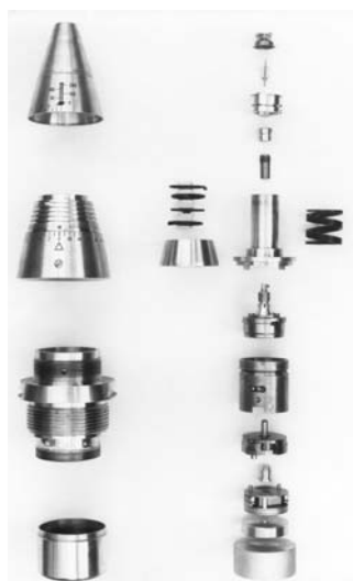
Détonateur d'obus Tavano, vers 1990. Les composants présentent des analogies avec les pièces d'horlogerie.
