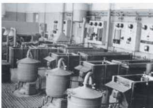
Annexe nord, bains servant au nikelage (galvanisation) des bâtis en aluminium des machines à coudre
