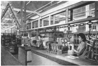
Détail du convoyeur du «shed fabrication». Long de 299 m, il dessert les principaux postes d'usinage des bâtis.
