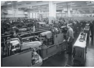
«Shed fabrication», machines de production, vers 1960. Répétitif, le travail consiste à charger la machine et à contrôler quelques pièces par série.
