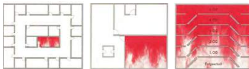
↑ Abb. 2: kleinzellige Struktur ist günstig für den baulichen Brandschutz (a. kleinzellig, b. grossflächig, c. grossvolumig).
